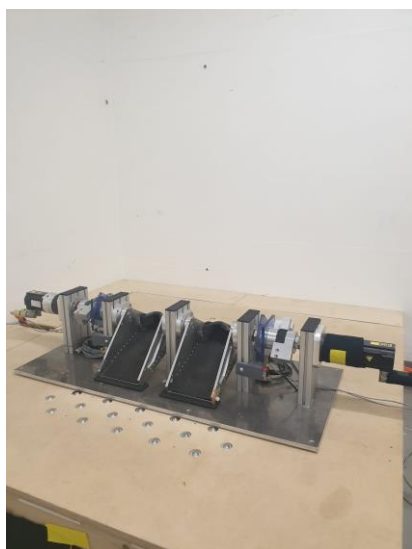
Figure 5. Plateforme sur laquelle les sujets devaient tenir en équilibre et qui envoyait les différentes perturbations. Les palettes étaient à l'horizontale et le sujet se tenait debout sur celles-ci en position stable.
